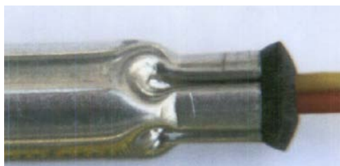
FOTO N°9 MUESTRA EL CIERRE DEL TAPÓN TERMOPLÁSTICO DEL DETONADOR ELÉCTRICO DE RETARDO.
