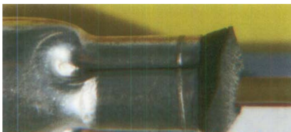
FOTO N°5 MUESTRA EL CIERRE DEL TAPÓN TERMOPLÁSTICO DEL DETONADOR Y SUS CARACTERÍSTICAS
