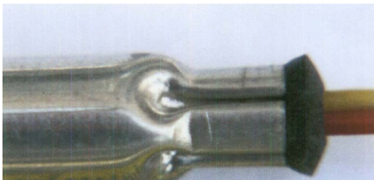
FOTO N°2 CIERRE DEL TAPÓN TERMOPLÁSTICO Y SUS CARACTERÍSTICAS.
