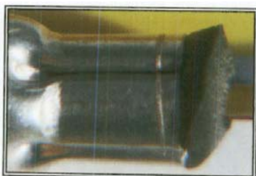
TAPÓN DE CIERRE ANTIES-TÁTICO, CORTE IRREGULAR
