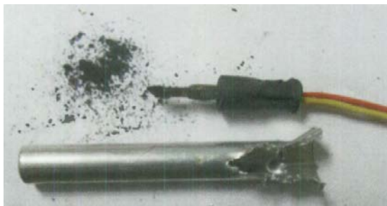
FOTO N°7 DETONADOR MECÁNICO Y SUS COMPONENTES DONDE SE APRECIA LA GOTA PIROTÉCNICA INDUSTRIAL ACTIVADA.
